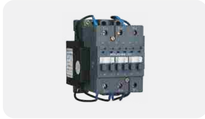
10、HUC1-40~75派生C型切换电容器接触器，适宜于交流50Hz，电压至380V的无功功率补偿中切换电容器，能有效地抑制合闸涌流。
