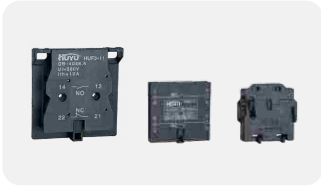
11、HUC1-9~30配用HUF 1 (顶挂)、HUF5 (侧挂) 辅助触头至4组，HUC1-40~75配用HUF1 (顶挂) 至6组及HUF2 (侧挂) 辅助触头至2组，HUC1-80~800配用HUF 3辅助触头 (侧挂) 至4组，辅助触头均为电气上分开，挂装自如。
